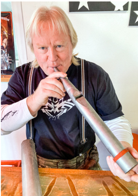
Die Metallpfeife hat ein Hütchen mit rotem Filz, das sich auf und ab bewegt. Der Stoff kann verrutschen oder schadhaft sein.
