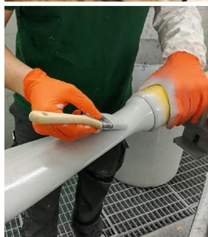
Sie werden mit Glasfaser (links) bzw. Kohlefaser beschichtet. Außerdem werden ihre Kanten mit Metall beschlagen, um sie robuster zu machen.
