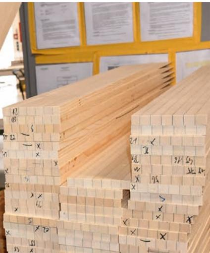
Der Kern der Propeller besteht aus vorbearbeiteten und verleimten Fichtenholzblöcken.
