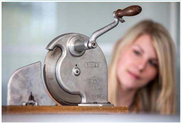
Aus der Kurbelmechanik der einstigen Messerputzmaschine entwickelte Franz Ritter 1932 die erste Brotschneidemaschine der Welt. Seit 1968 gibt es sie auch mit Elektromotor.
