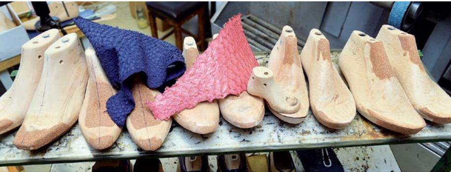
Jeder Fuß wird vermessen. Aus Kunststoffrohlingen fertigt der Schuhmacher ein originalgetreues Duplikat aus Holz – den Leisten, der mit der Feile auf Maß gebracht wird. Diese Modelle werden in zahlreichen Regalen für die Kunden aufbewahrt.
