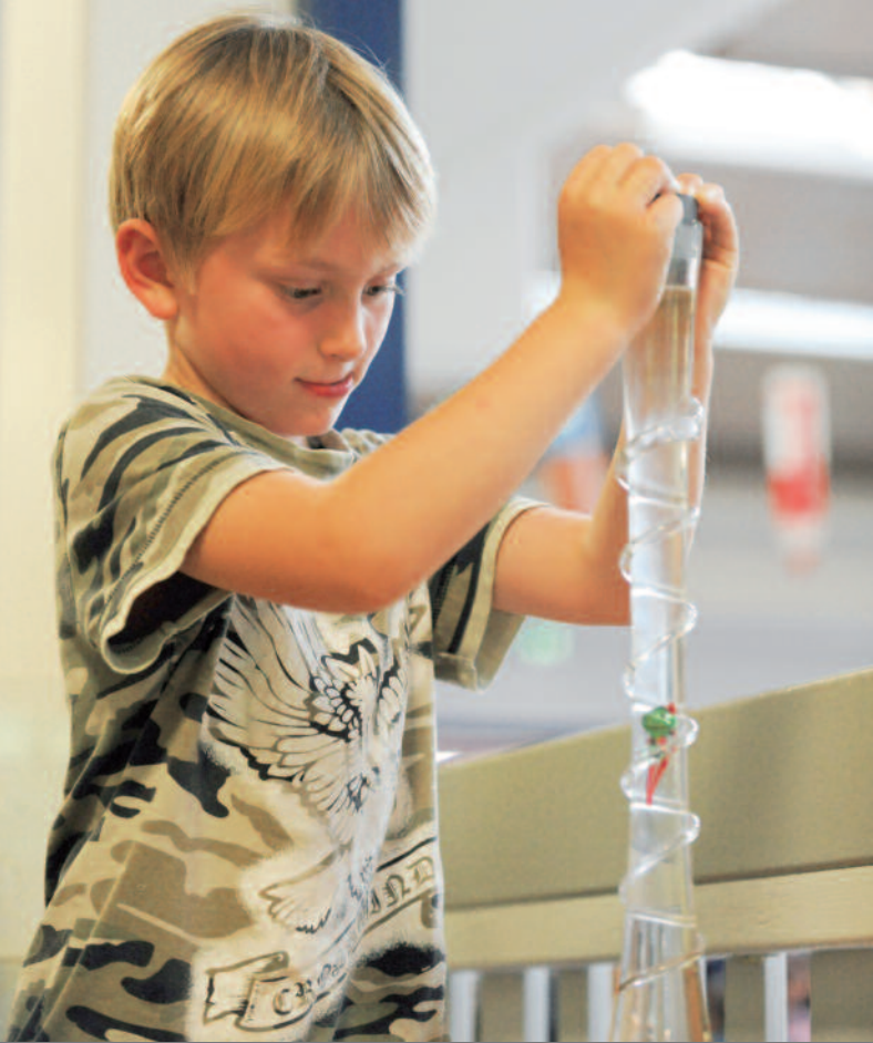
Der Cartesische Taucher ist eins der Experimente der Miniphänomente: Durch Druck ändert sich der Auftrieb der Flasche, die dadurch in ihrer Bewegung beeinflusst werden kann. Der Bub drückt oben auf den Gummistopfen und in der Vase bewegt sich das Fläschchen.
