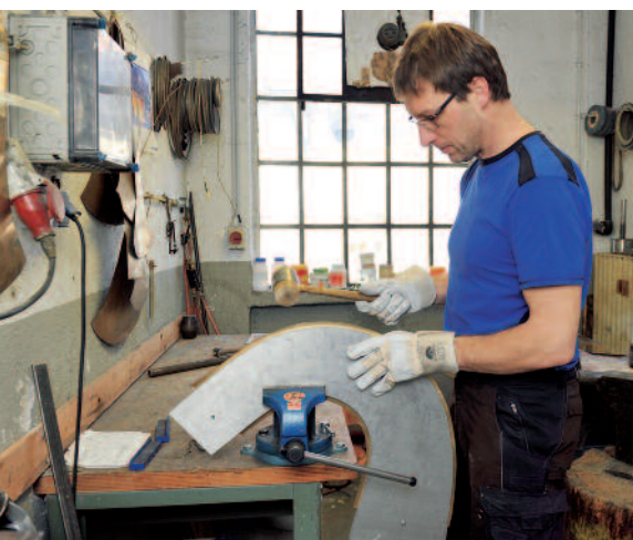
▲ Hier entsteht eine Melton in Handarbeit: Reinhold Koch schneidet ein Teil aus dem Rohblech.
